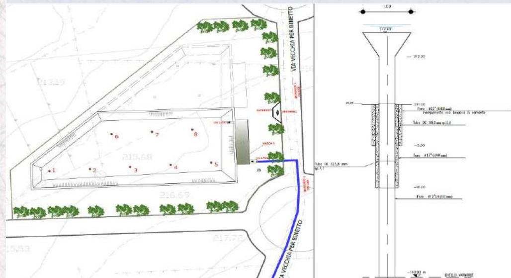
OPERE DI SCARICO – Planimetria dell'area da espropriare e sezione tipo dei pozzi disperdenti
