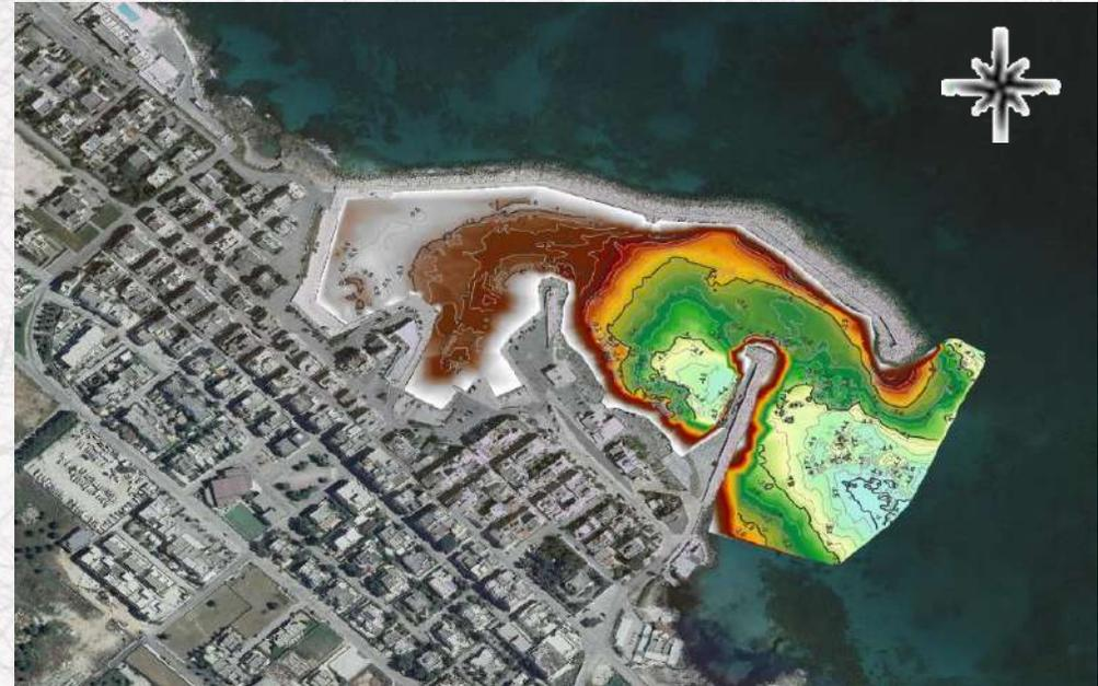
RILIEVO BATIMETRICO – stato dei luoghi su base Ortofoto
