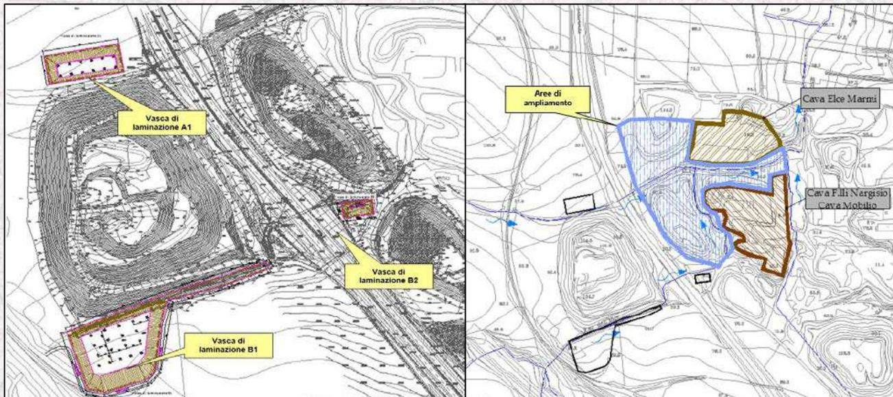
OPERE DI PROGETTO – Planimetria con indicazione delle vasche di laminazione (a sx) e dell'area di ampliamento della cava (a dx)
