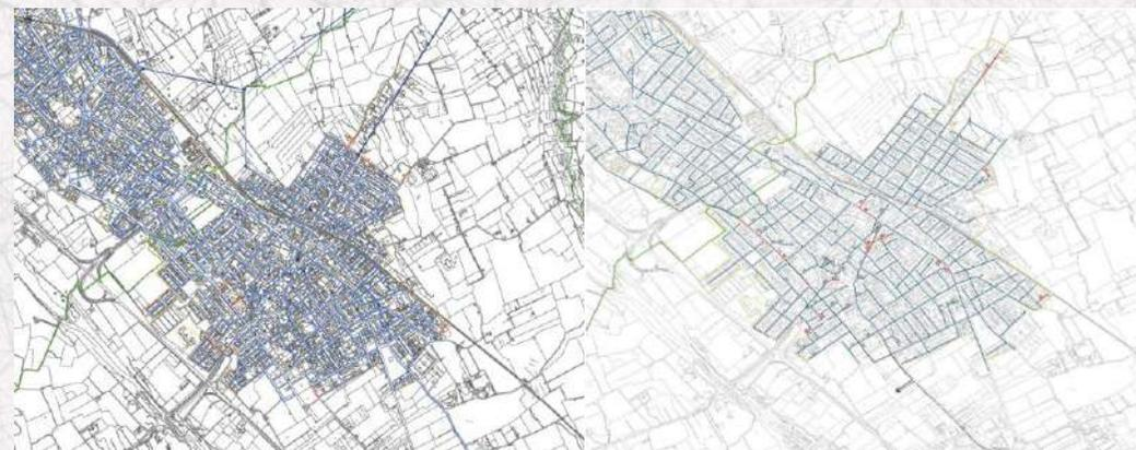
RETE IDRICA (a sx) e RETE FOGNARIA (a dx) – Planimetria generale di progetto su base aerofotogrammetrica (in rosso i rami previsti dagli interventi di progetto)
